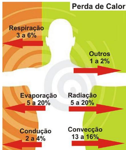
**Figura 1.** Fatores que influenciam no conforto térmico e na perda de calor.
